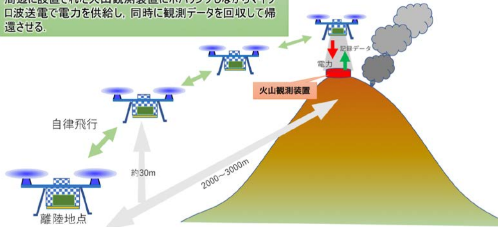
第1図 空中マイクロ波送電技術を用いた火山観測・監視装置の開発の概念図
