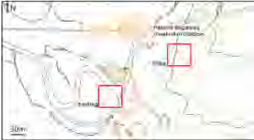
図 41. SfM 処理で推定した DSM と DEM の差の局所的な評価のために選定した、平坦な地形（大涌谷駐車場付近：parking）と急峻な地形（大涌谷の斜面：slope）（赤枠で表示）。国土地理院 GSI Maps を使用。
