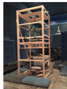
アンテナ取付木製枠
