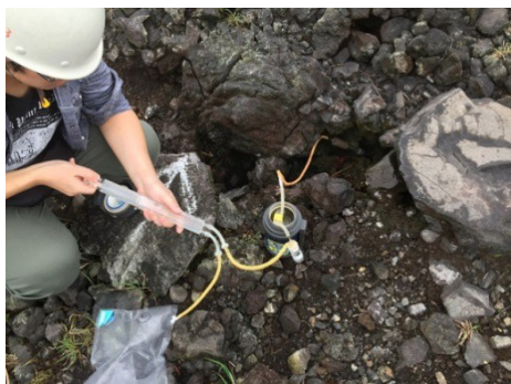
写真 7 X-15 地点における噴気の採取の様子
