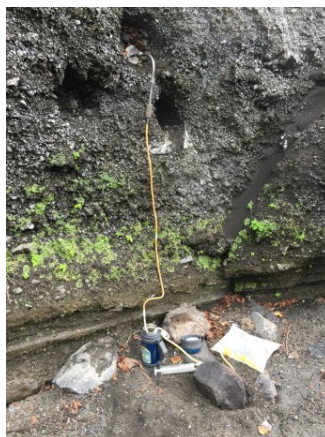
写真 5 楡形山西山麓谷の噴気孔と採取器具
