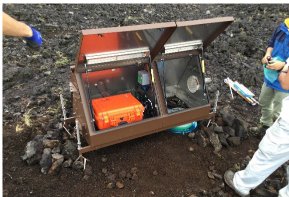
写真 8 設置した筐体とその内部に配したチャンバー部（右側）と計測・制御ボックス（左側、オレンジ色）。
