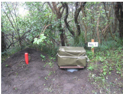
写真 3. 広帯域地震計観測点の設置完了状態 (FGY1)
