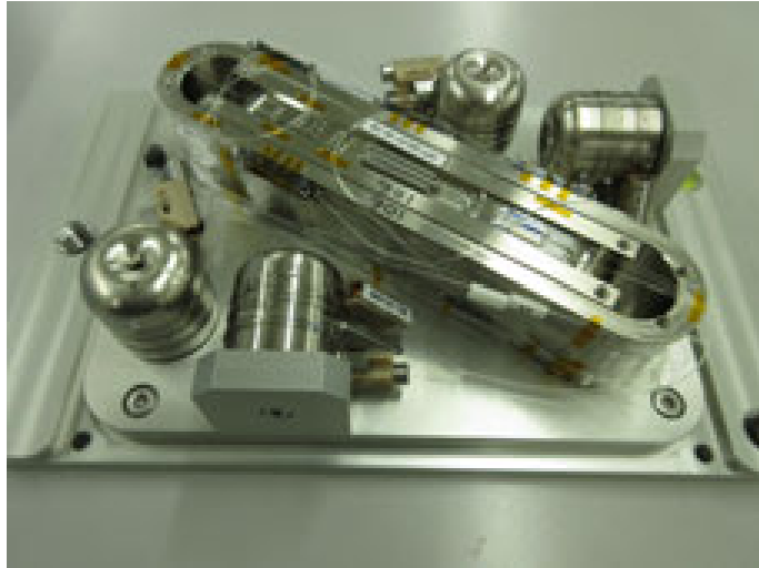
写真8 3成分センサ格納筐体内部
