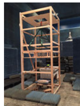
アンテナ取付木製枠
