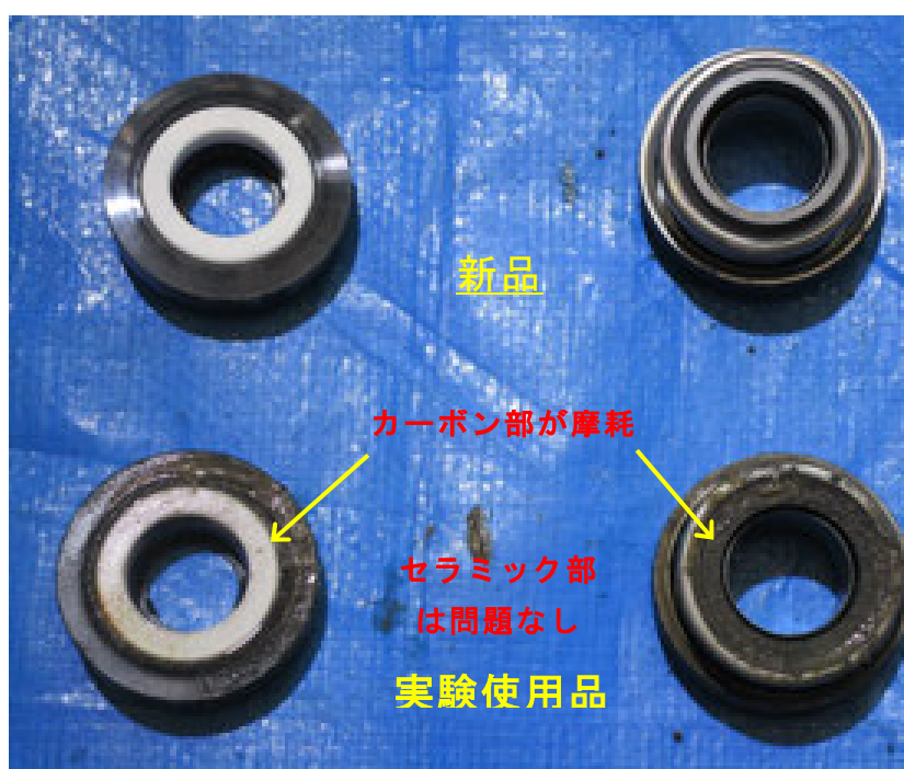
写真18. メカニカルシールの摩耗
