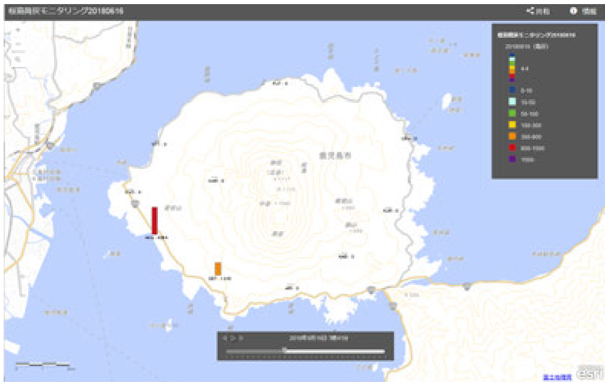
図 22. WebGIS に表示されたディストロメータによる降灰観測データ
