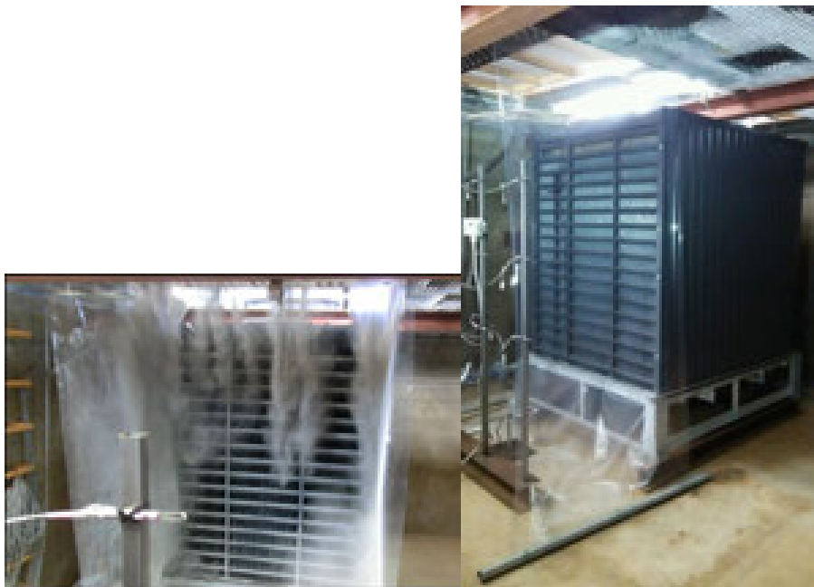
写真11. 冷却塔前方上方の篩をしたから見たところおよび降灰状況
