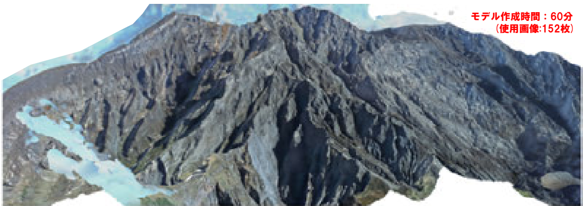
図 14 斜め写真から作成した3Dモデル
