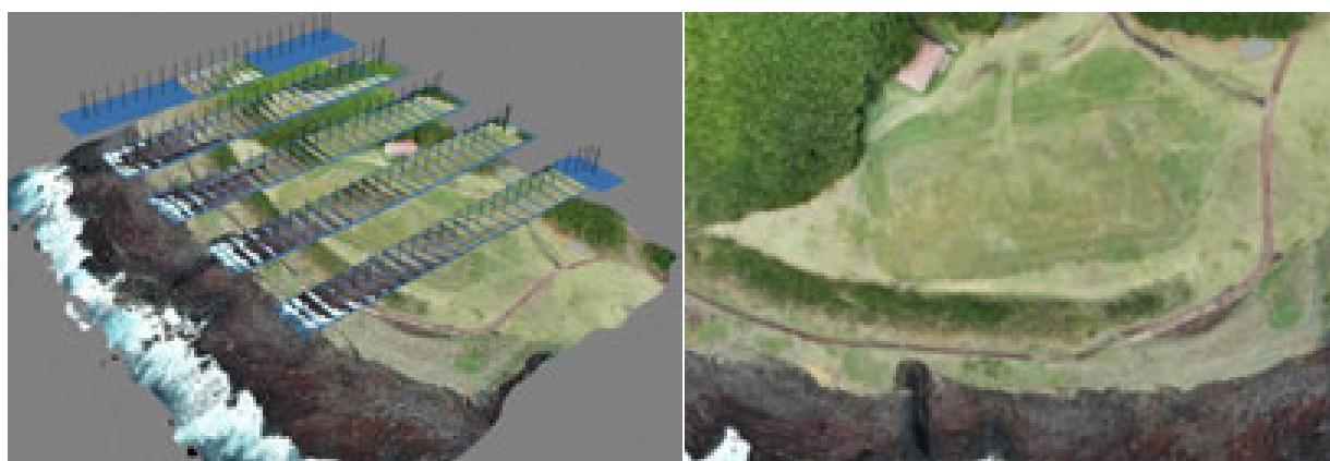
図 3 トウシキの鼻東方地点での撮影状況(左)と取得した画像からオルソ写真(右)
