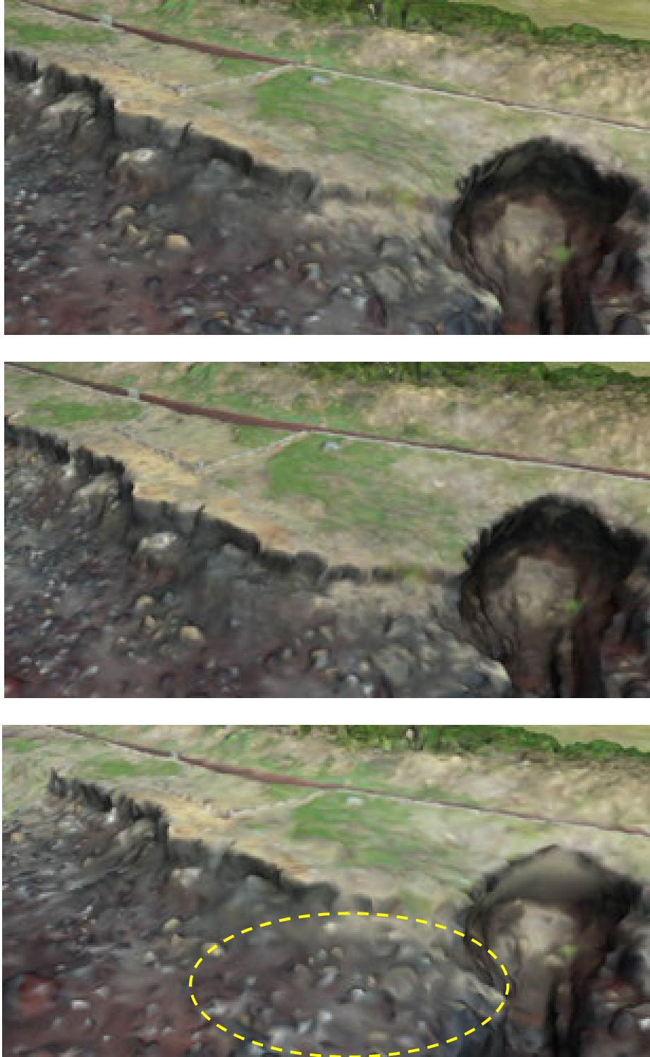
図 9 撮影高度 50m におけるラップ率の違いによる DSM モデルの変化 （上：前後ラップ率 90%、左右ラップ 80%、中：前後ラップ率 90%、左右ラップ 60%、 下：前後ラップ率 80%、左右ラップ 40%）
