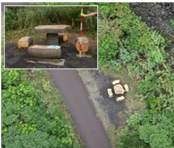
図 6 飛行高度 90m の場合の地物認識度
