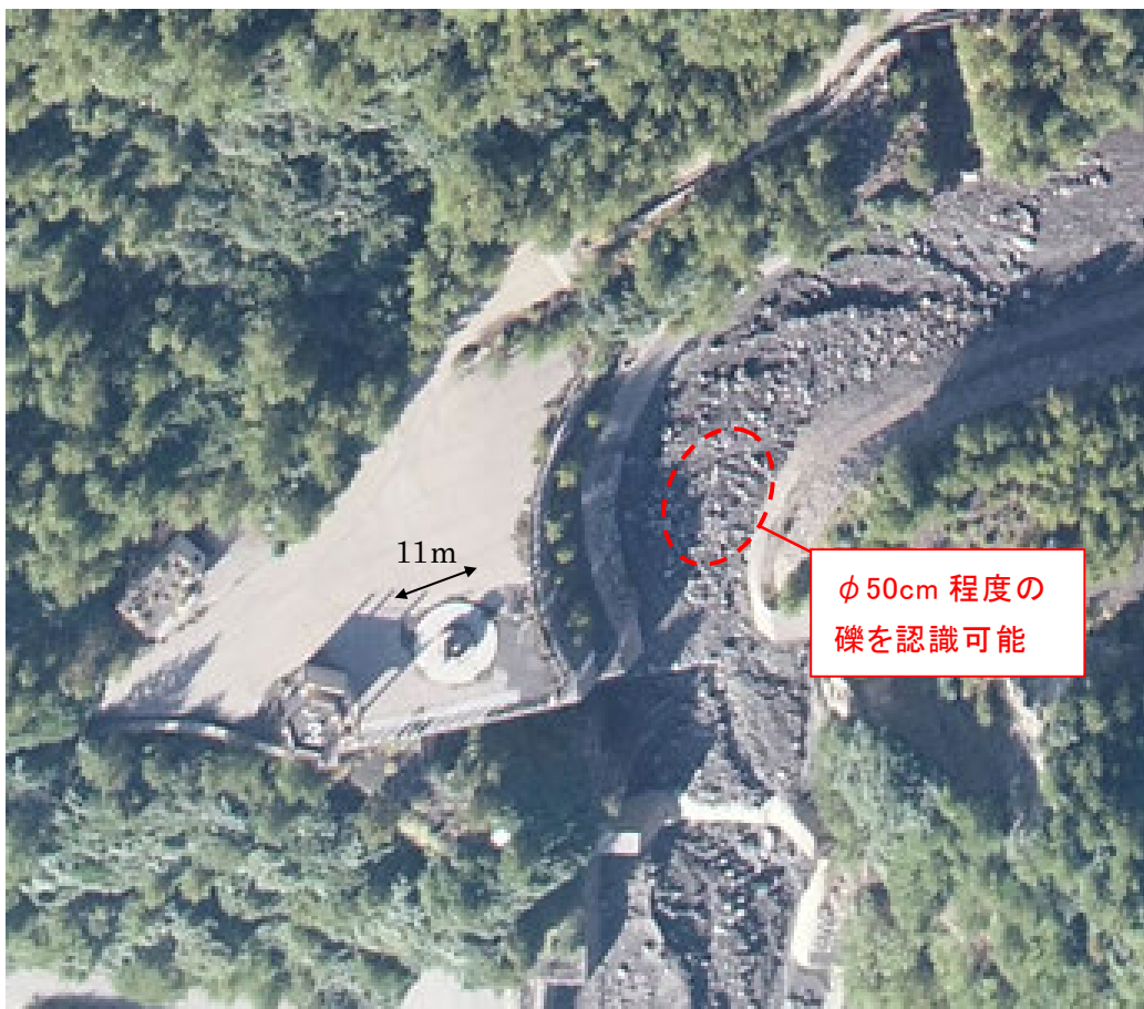
図 14 対地高度 350m で撮影した画像による地物認識度
