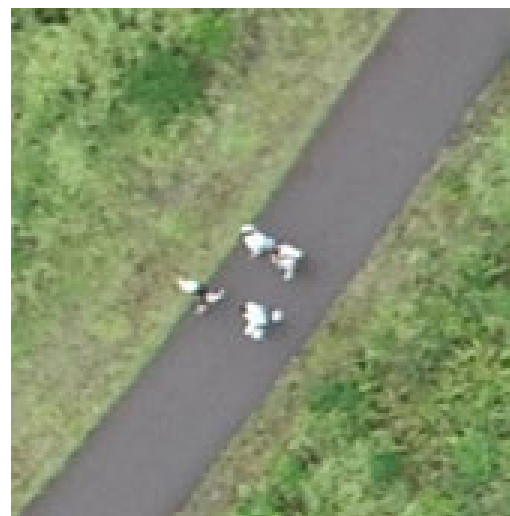
図 6 飛行高度 90m の場合の地物認識度
