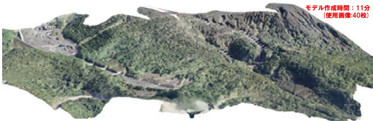
図13 高高度撮影の静止画(垂直写真)から作成した3Dモデル
