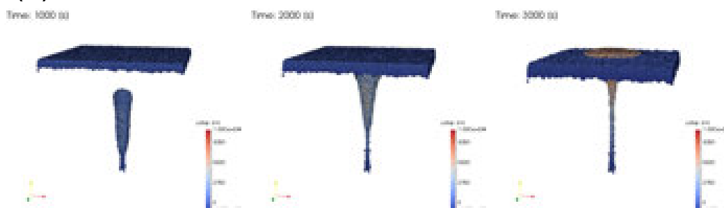
図9 個別要素法による岩脈貫入シミュレーション(マクロモデル)の例. 初期過剰圧として, 静岩圧比が(a)8倍, (b)16倍, (c)32倍としたもの. およそ10倍以下では噴火未遂, 10倍以上で噴火に至ることが分かった.
