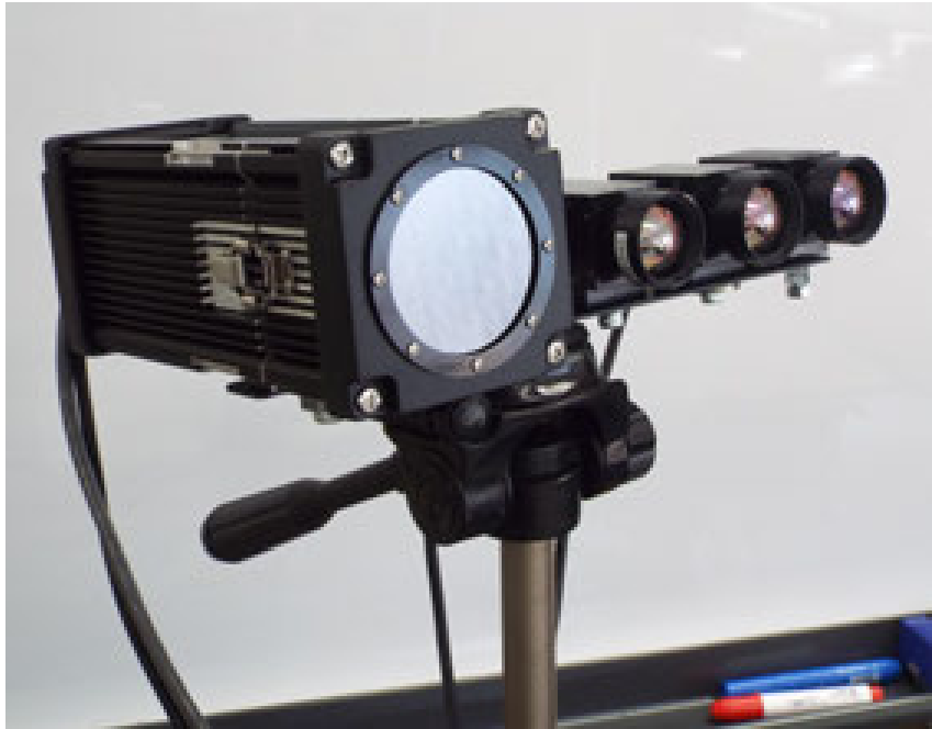
写真 2. SPIC-UC (XGA 型) 1 台と SPIC-UC (VGA 型) 3 台の同期計測装置
