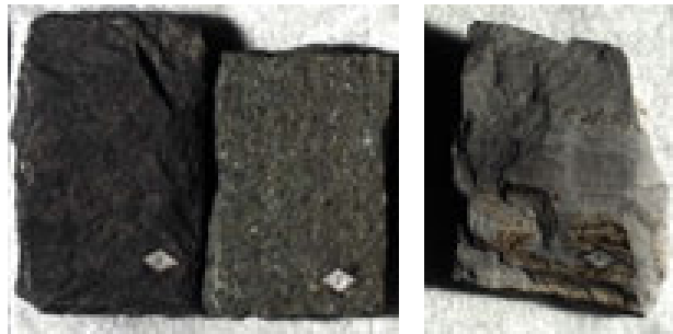
写真 11. 整形試料 ( \phi 16mm, h=7mm)。左から、玄武岩、安山岩、流紋岩 (R/G/B=635/551/471nm)。
