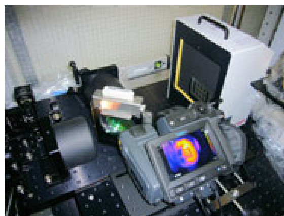
図 16. 赤外域干渉計 BBM（CCM）構成概要 写真 7. 赤外域干渉計 BBM（CCM）外観
