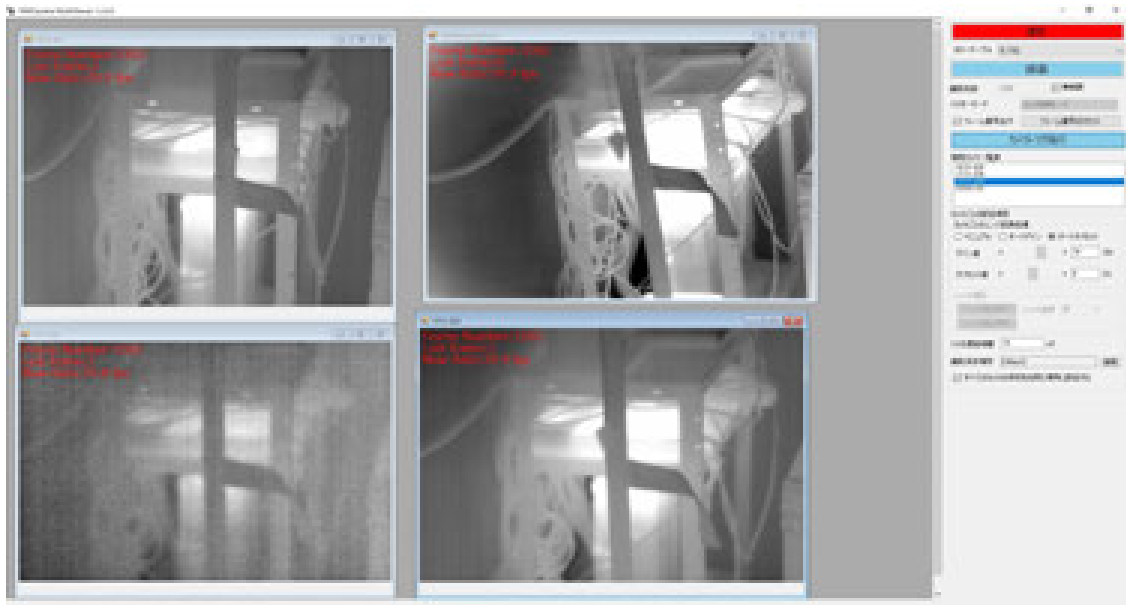
図 8. SPIC-UC (XGA 型) 1 台と SPIC-UC (VGA 型) 3 台での同期計測ソフトの計測画面
