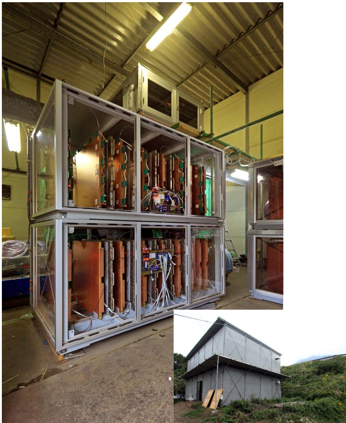
図 1. 桜島に実装された超軽量高解像度ミュオグラフィ火山観測システム。インセットは観測所外観。
