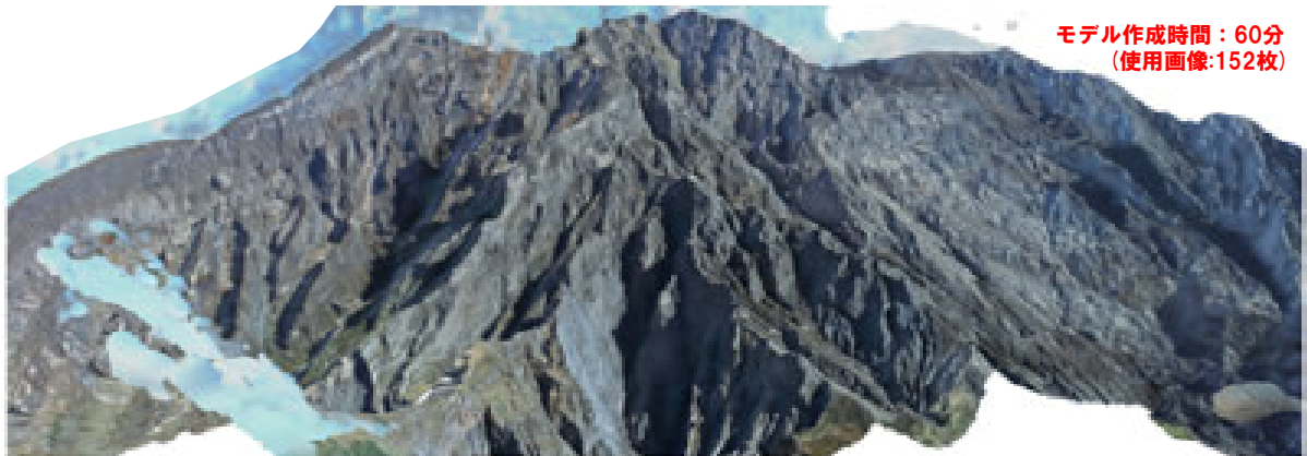
桜島における実証実験にて、ドローンによる斜め写真から作成された桜島の 3D モデル。
