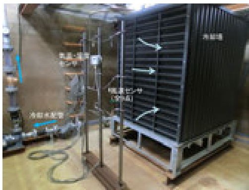
開放型冷却塔を対象とした降灰影響評価実験の様子。
