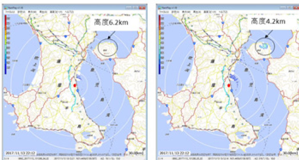
図8 錦江湾高等学校に設置したレーダーにより観測された2017年11月13日の桜島南岳爆発的噴火の噴煙反射強度。錦江湾高等学校に設置したレーダーではHSQ スキャンでデータが取得されるが、高度4.2kmまではエコーが検出できたが、高度6.2kmではエコーが検出されなかった。
