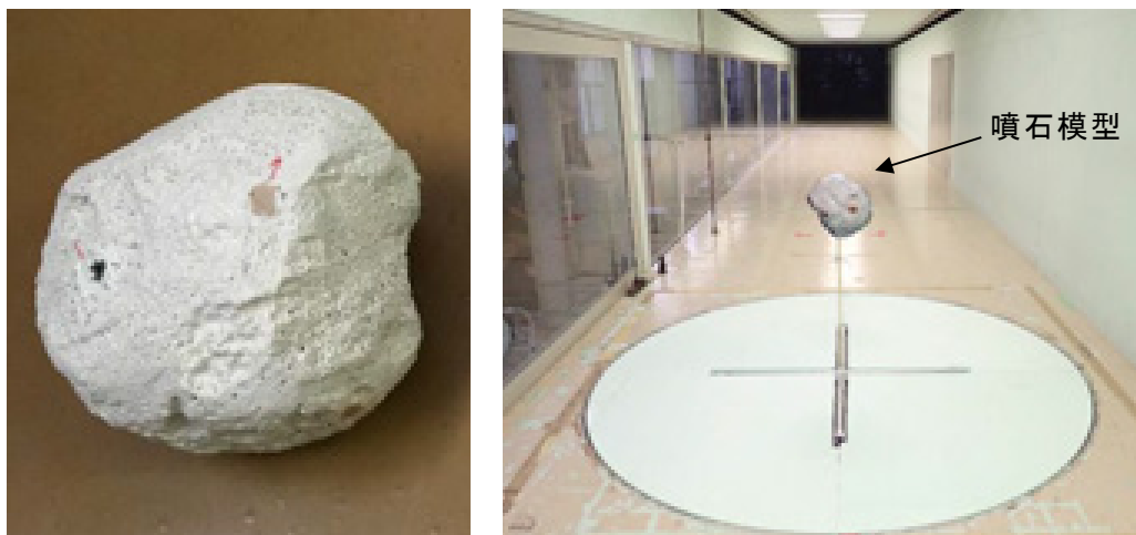
図 43 噴石模型（左）および風洞内の設置状況（右）。
