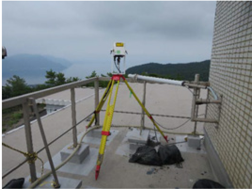
図 36 ハルタ山に設置したドップラーライダー。
