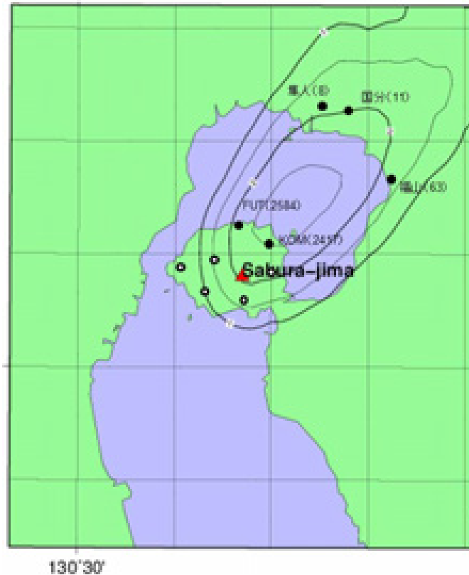
図 48 火山灰拡散シミュレーションによる降灰量の分布と観測された降灰量。22:00 から 6 時間分を計算した。火山灰拡散シミュレーションによる降灰量は対数スケールで示した。1=10g/m 2 、2=100g/m 2 。カッコ内の数字は実測値（単位：g/m 2 ）。FUT と KOM はディストロメータによる値。白丸はディストロメータを設置しているが火山灰粒子を検知しなかった観測点である。隼人、国分、福山は鹿児島県の測定値。
