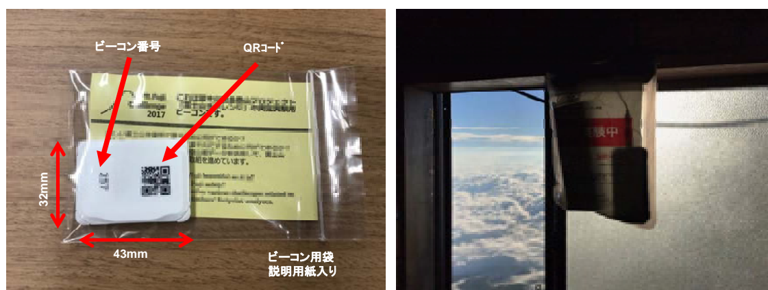
図 2 富士山チャレンジで配布したビーコン(左)と山小屋に設置したレシーバー(右)
