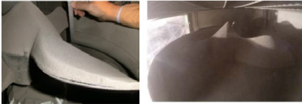
図 16 ファンへの堆積と起動の状況(実験 1.50mm)
