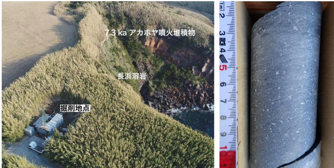
写真1 薩摩硫黄島での深深度ボーリング掘削調査の様子(左)とボーリングコア写真(右)。7,300年前のカルデラ形成噴火の噴火推移および先行活動の履歴を明らかにするために、平成29年度から平成30年度にかけて330m掘削する。
