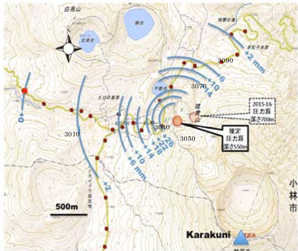
図4 えびの高原～硫黄山区間の水準路線と2015年6月～2018年3月6日に記録された上下変動分布。推定された圧力源の水平位置も同時に示す。国土地理院電子地形図（タイル）を使用した。
