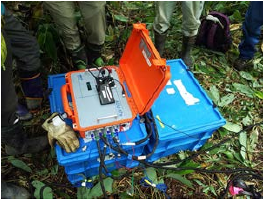
図 10 本業務で用いた MT 探査装置 (ADU-07e)。
