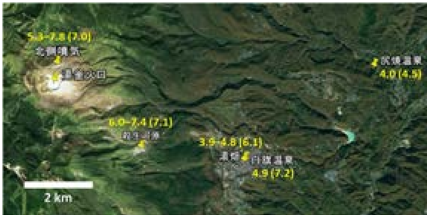
図1 草津白根山における噴気、温泉ガス、温泉水採取地点と ^3\text{He}/^4\text{He} 比（黄色の数字、単位は R_A 。 R_A は大気 ^3\text{He}/^4\text{He} 比 = 1.4 \times 10^{-6} を単位とする値）。括弧内の数字は大気補正 ^3\text{He}/^4\text{He} 比。白旗温泉と尻焼温泉以外の地点については、2014年～2017年にかけて複数回採取した試料の ^3\text{He}/^4\text{He} 比の範囲と、大気補正 ^3\text{He}/^4\text{He} 比の平均値を示している。
