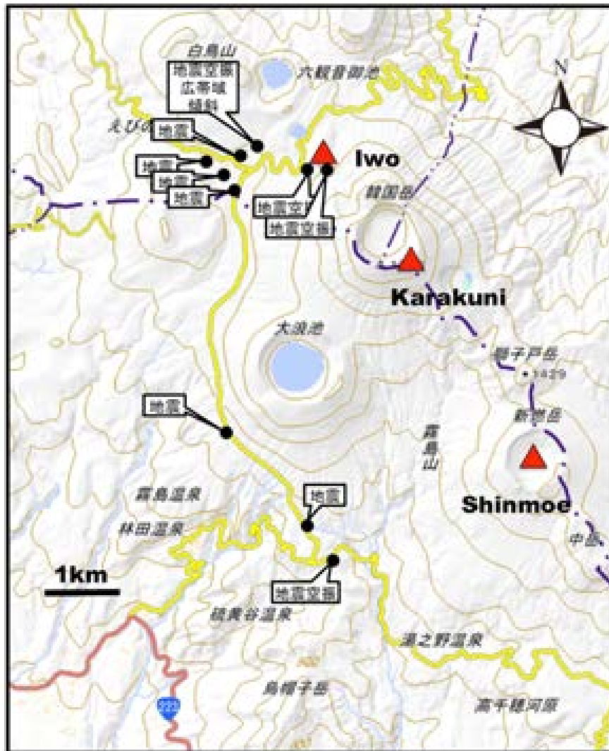
図1 本研究プロジェクトで設置された地震計・空振計アレイの配置. 広帯域地震計・傾斜計の設置位置も示す.
