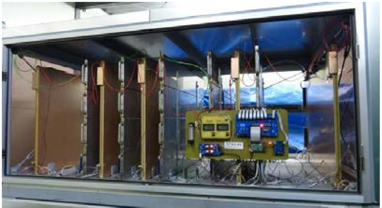
図1 ミュオグラフィ観測システム(MOS)へ実装された軽量、高分解能ミュオン検出器。
