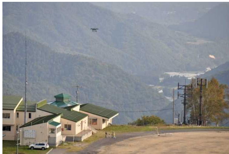
写真 6：無人航空機のフライト試験。500 m 離れた地点から離陸を行い自律航法で、70 m 低いグラウンドに自動着陸させた。
