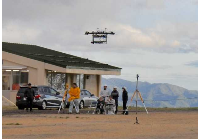
写真 5：無人航空機のフライト試験。後方のトータルステーションで無人航空機の位置を測定する。また風向風速・気圧・温度の気象ステーションも実験場に設置した。
