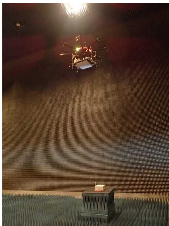
写真3：電波暗室内での空中マイクロ波送電・データ回収実験
