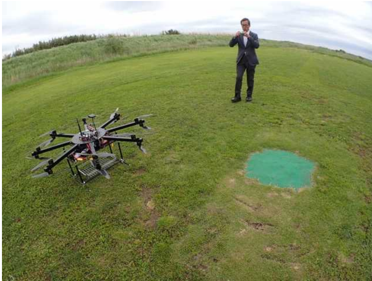
写真 2 : 第 2 回目のフライトの結果。無人航空機は離陸地点（緑のシート の場所）から約 3 m 離れたところに自律航法で着陸した。
