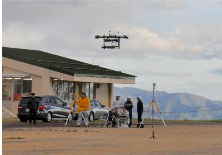
尾瀬ほたか高原スポーツパークにおける無人航空機のフライト試験。導入された大型無人航空機は、10kgの荷物を積載して7分間飛行することができる。飛行時間を延長するためには、搭載機材の軽量化も不可欠である。
