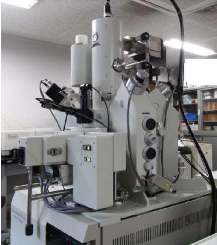
写真1. 東京大学地震研究所に2017年3月に設置された火山噴出物の分析・解析用のフィールドエミッション型電子線マイクロプローブ (FE-EPMA)。微小領域の高精度定量分析によって、火山の物質科学研究を牽引することが期待されている。
