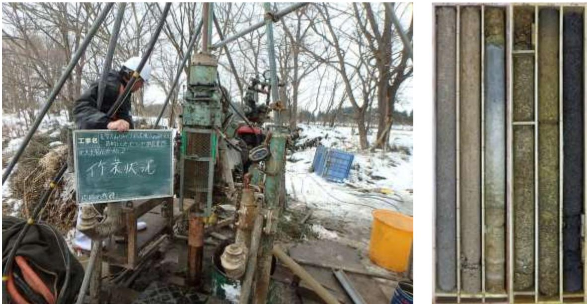
写真2 南西北海道でのボーリング掘削調査の様子（左）とボーリングコア写真（右）。南西北海道は比較的積雪が少なく、ボーリング掘削調査が可能であったため、南西北海道の活火山の噴火履歴を検討するために、これら火山の東方（千歳市）において実施した。
