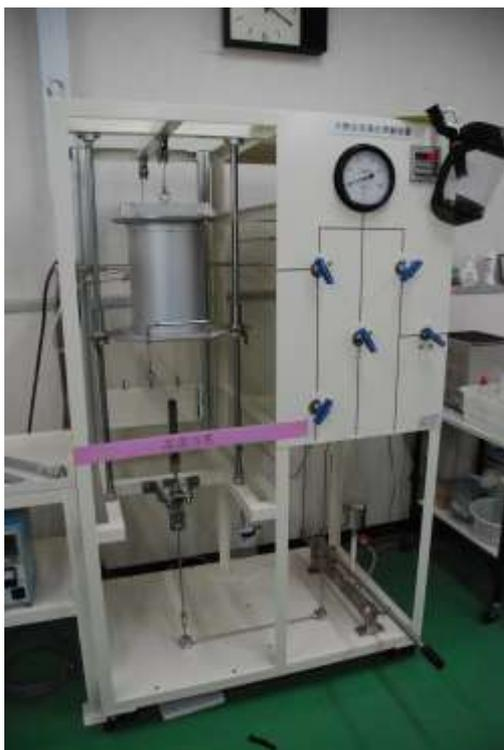
図10 水熱合成減圧実験装置
