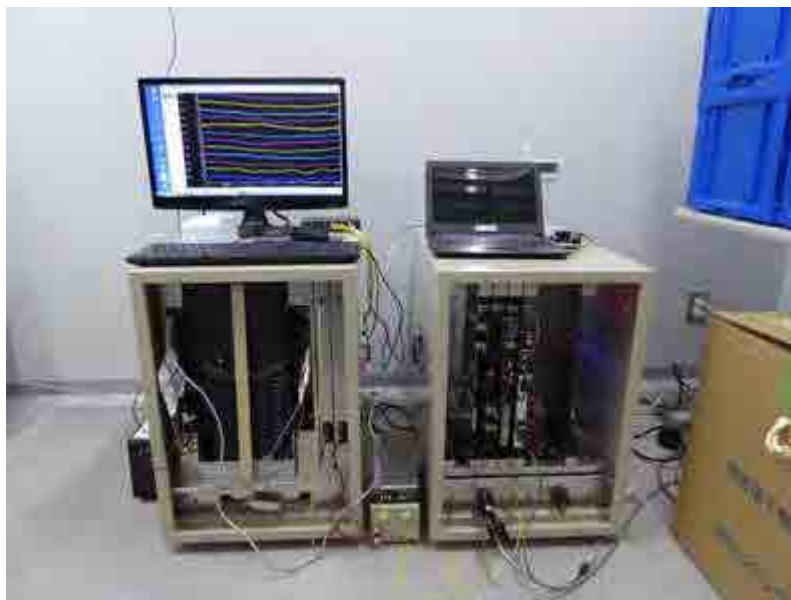
写真2. 位相シフト光センサシステム 光信号制御装置
