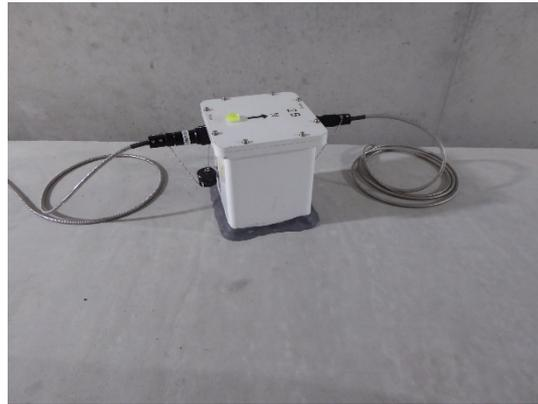
写真1. 位相シフト光センサシステム 位相シフト光センサ
