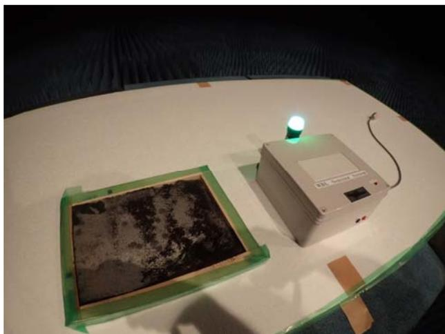
写真3 マイクロ波受電アンテナ付き温湿度計測ユニット
