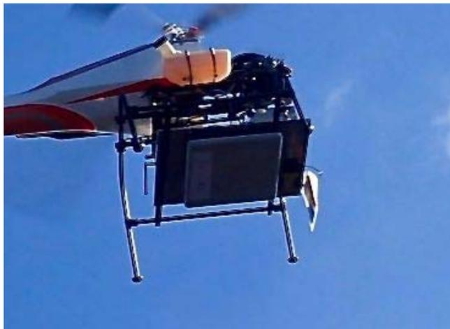
写真2 広域照射タイプ送電アンテナ
