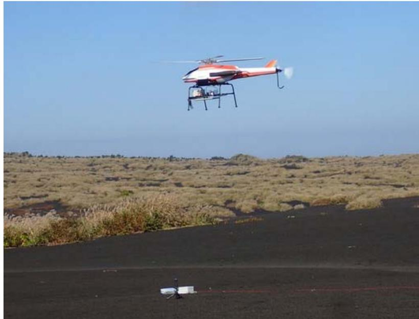
伊豆大島における無人航空機を用いたマイクロ波送受電およびデータ回収実験風景。日本で初めての屋外での実験であり、空中からのマイクロ波送受電およびデータ回収に成功した。
