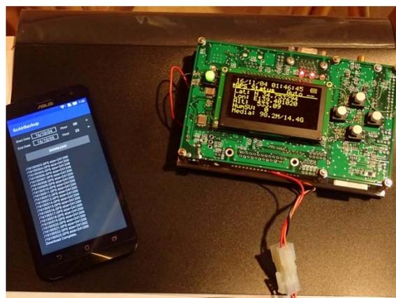
試作した GNSS 受信装置(右) とデータ回収装置 (左)。前者は地上設置し、後者は無人航空機に搭載する。データは無線 LAN を使用して伝送されるが、良好な伝送状態を保つために、GNSS 受信装置を金属筐体から取り出して、基板剥き出しの状態で使用した。距離 10m までは高速データ回収は可能であり、低速ながらも 60m 離れた所からデータ回収も可能であった。
