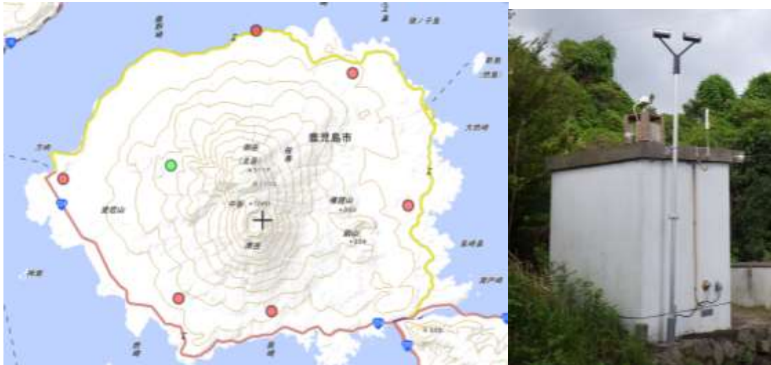
図5 桜島におけるディストロメータの配置図。赤丸が本課題による設置場所。
