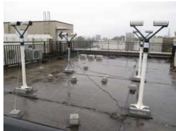
図 6(b) 4 台のパーシベルによる観測風景
