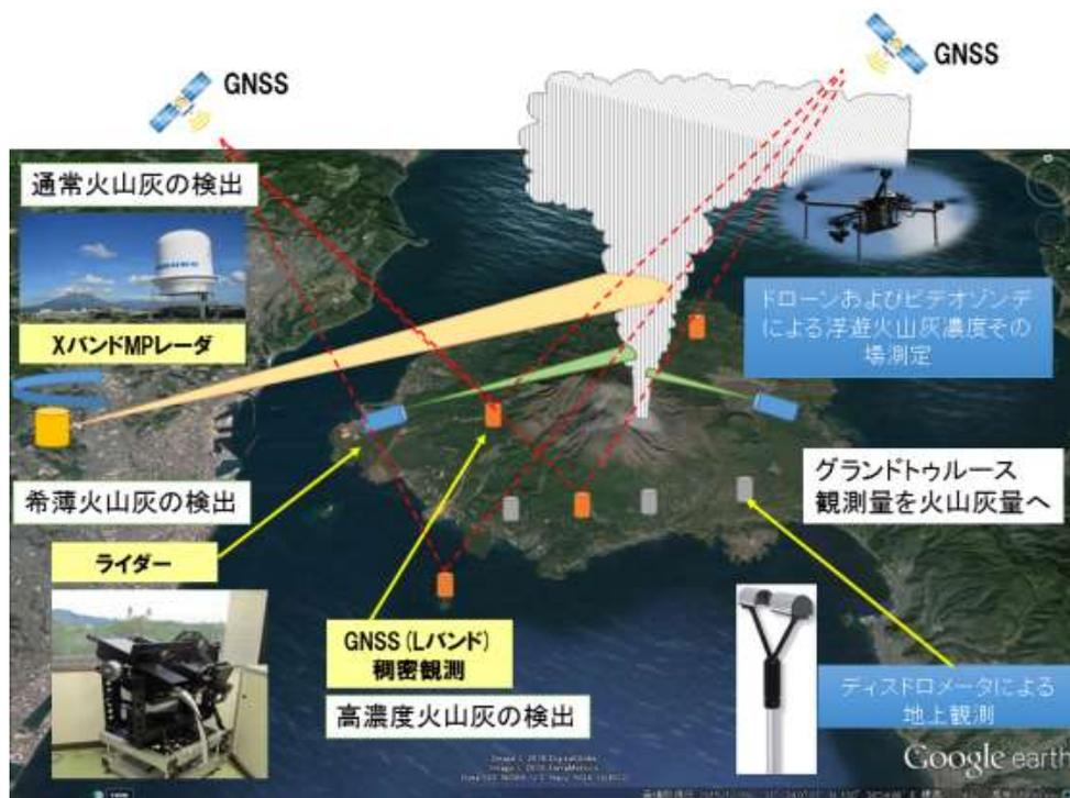
桜島を対象に行われる、リモートセンシング（レーダー、GNSS、ライダー）および地上観測（ディストロメータ）からなる、火山灰観測のためのマルチパラメータ観測網の構築。
