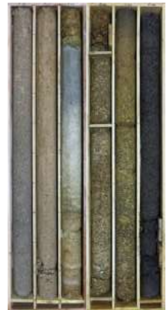
写真2 南西北海道でのボーリング掘削調査の様子（左）とボーリングコア写真（右）。南西北海道は比較的積雪が少なく、ボーリング掘削調査が可能であったため、南西北海道の活火山の噴火履歴を検討するために、これら火山の東方（千歳市）において実施した。
