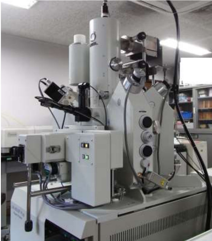
写真1. 東京大学地震研究所に2017年3月に設置された火山噴出物の分析・解析用のフィールドエミッション型電子線マイクロプローブ (FE-EPMA)。微小領域の高精度定量分析によって、火山の物質科学研究を牽引することが期待されている。
