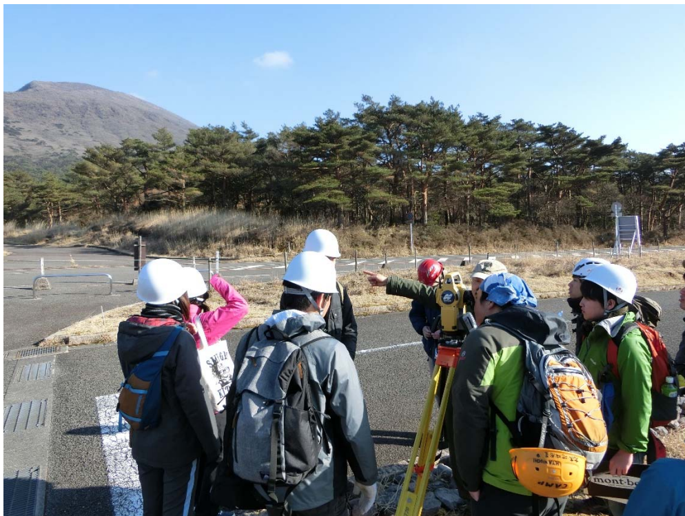
火山研究人材育成コンソーシアムの野外実習と連携して実施した霧島山水準測量。 測量機器の取り扱いを実機を用いて現場で指導した。
