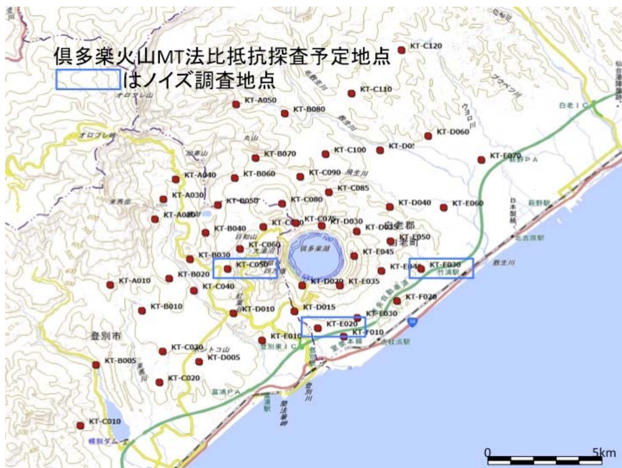
図 7. 平成 29 年度実施予定の倶多楽地下比抵抗構造観測候補点。予備観測点を含め、平成 28 年度は地点の選定、用地交渉等を実施した。候補点のうち、電磁ノイズが劣悪であると予想される青四角で囲んだ点で、予備的な観測を実施してノイズ環境を調査した。
