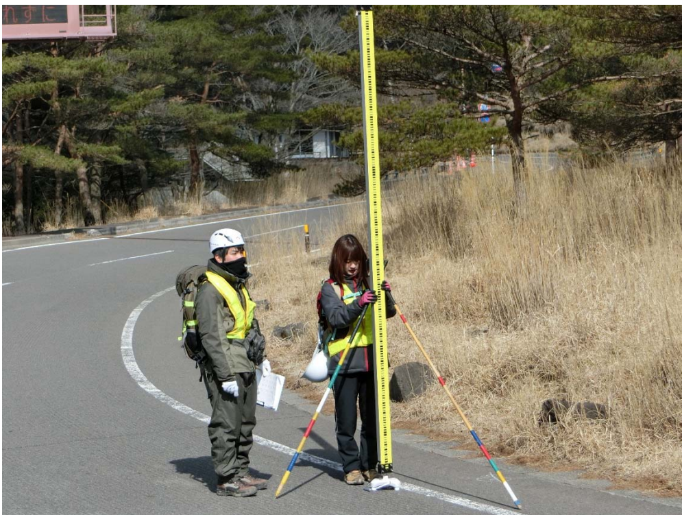
火山研究人材育成コンソーシアムの野外実習と連携して実施した霧島山水準測量。 標尺の支持の仕方での測定の精度が変わることを身をもって経験する。
