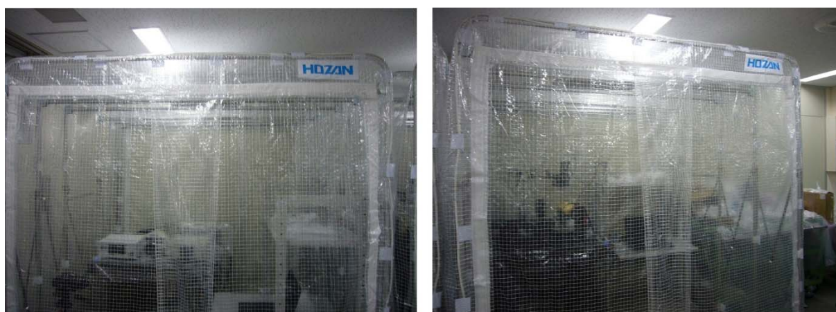
図7 クリーンブース（左）黒体炉用、（右）積分球型非冷却型カメラ狭帯域特性評価装置用
